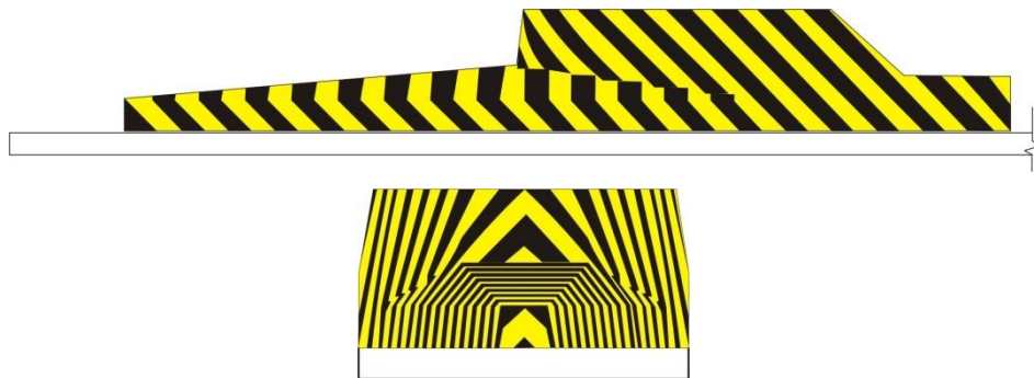
Sử dụng vạch 8.1 trên đảo phân làn tại trạm thu phí – Mẫu 1
